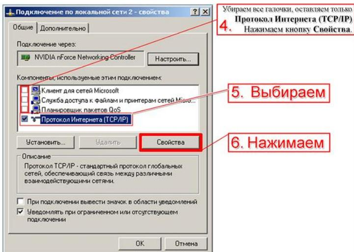
4. Убираем все галочки, оставляем только **Протокол Интернета (TCP/IP)**. Нажимаем кнопку **Свойства**.
